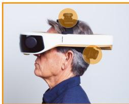
Coloque el SimVis Gekko sobre la cabeza del paciente utilizando el sistema de monitorización de la pupila y corrija su error refractivo.
